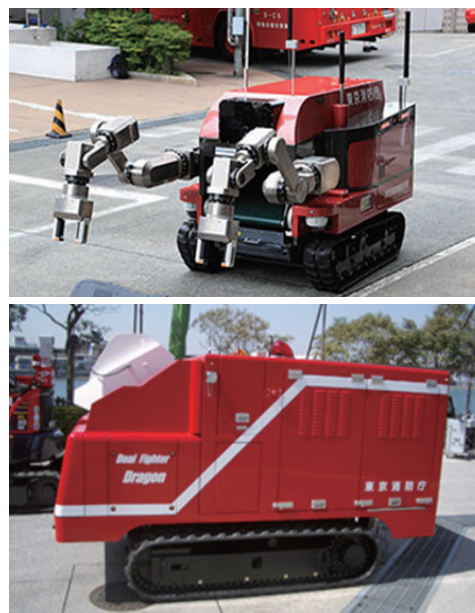
[그림3] 인명구조 로봇 및 무인 주행 살수차 출처: 동경 소방청
