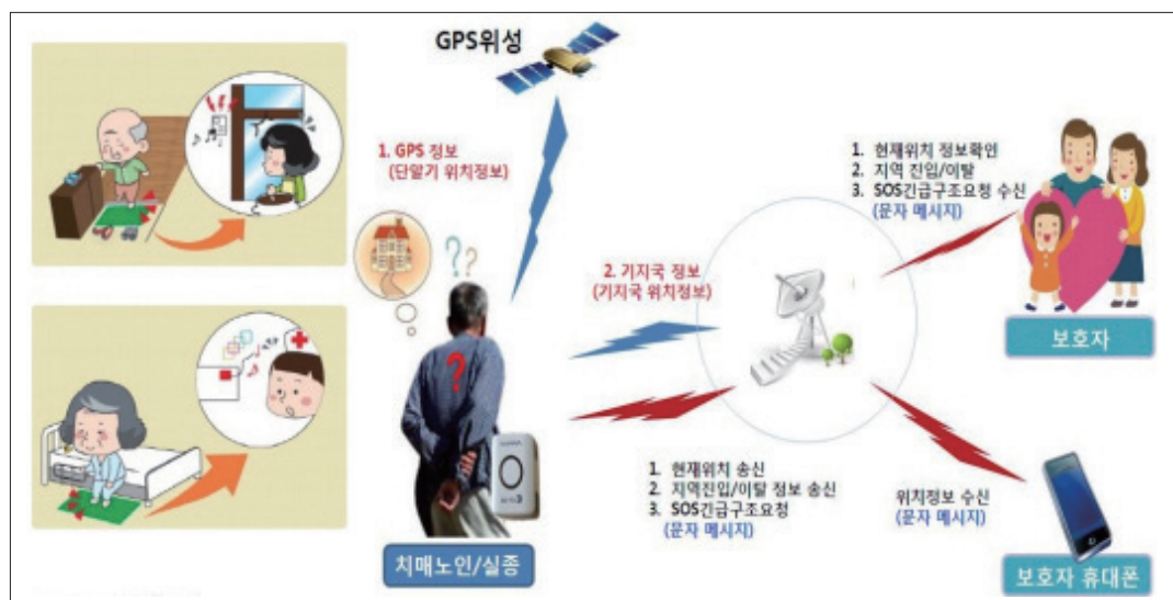
[그림 3] 치매노인 실종방지 스마트슈즈 작동 개요
