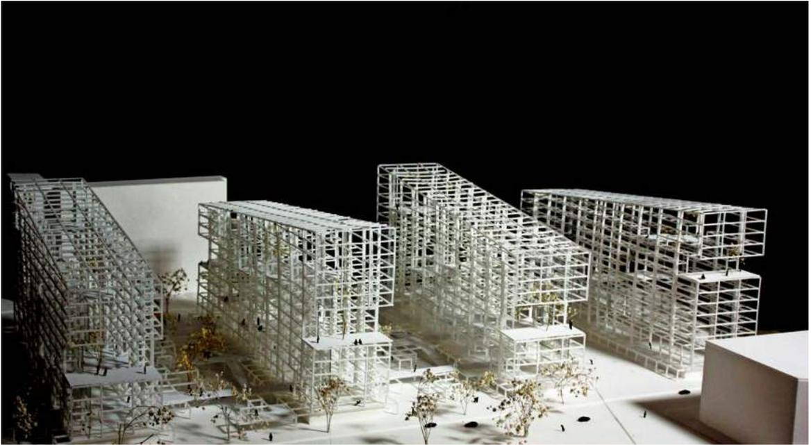
기존 리모델링 방안은 신 구조체의 하중이 기존 건물에 가해지지만 이러한 방식은 낙후된 아파트와는 적합하지 않다고 생각하였고 이에 기존 건물에 하중을 가하지 않는 자립형 구조체를 생각하였으며, 이는 기존의 구조적 문제를 해결할 수 있을 뿐만 아니라 점진적 확장 및 분화 등의 가능성을 제공한다.
